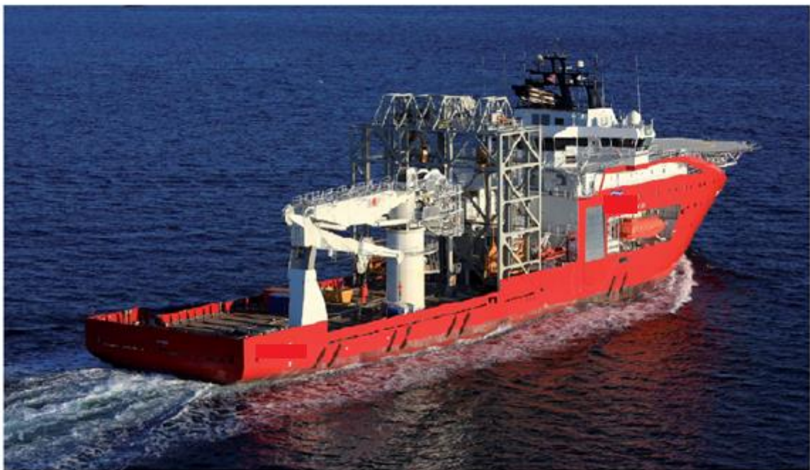
Figura 11: Unidade SESV de instalação e manutenção de equipamentos submarinos
