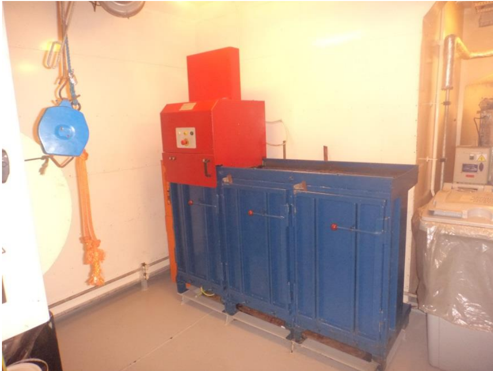
Figura 31: Empacotadora de resíduos sólidos no setor de convés em uma unidade SESV
