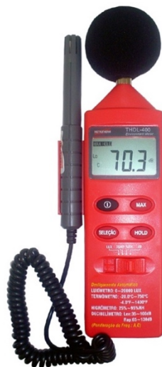
Figura 14: Aparelho usado para medições de temperatura, umidade e nível sonoro no pavimento técnico do EAS
