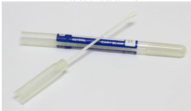
Figura 17: Swab utilizado para a coleta de amostras nos filtros G3 e Bolsa do EAS
