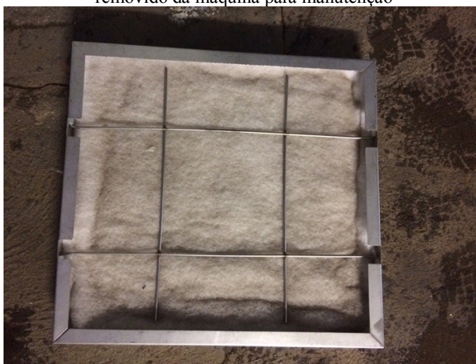
Figura 42: Filtro G4 de 500 mm x 500 mm em grelha metálica, removido da máquina para manutenção
