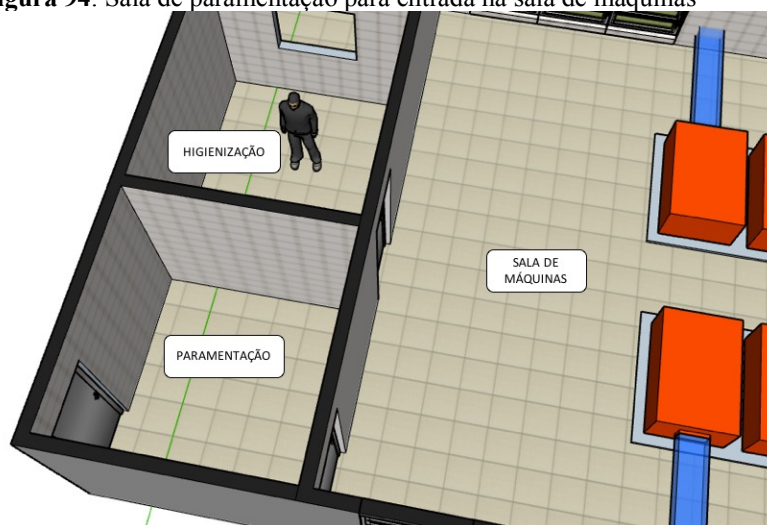
Figura 94: Sala de paramentação para entrada na sala de máquinas
