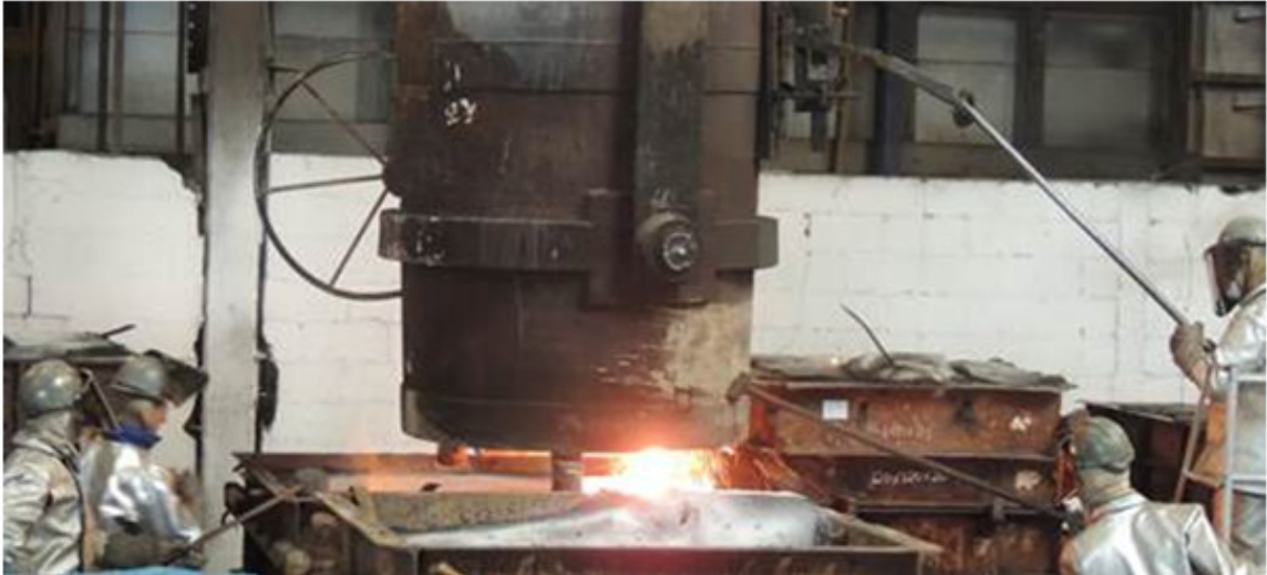
Figura 5 - Vazamento de metal líquido no molde de areia
