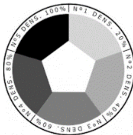
Figura 14 – Ilustração da escala Ringelmann usada como referência para a medição da densidade da fumaça.
