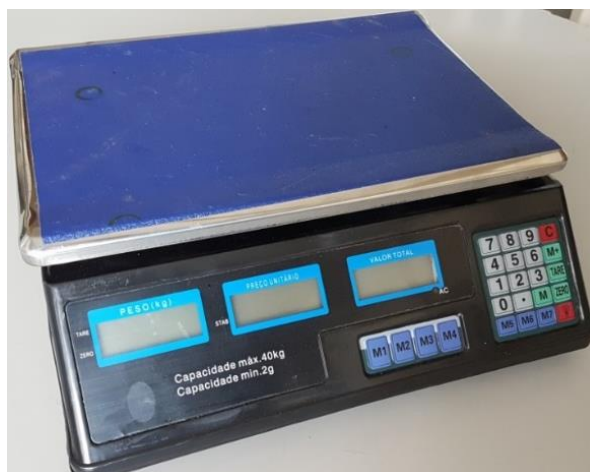
Figura 10 - Balança capacidade até 40 kg utilizada para pesagem dos REE
